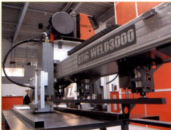
Rys. 3 Maszyna do spawania wręg wzmacniających burty kontenerów
