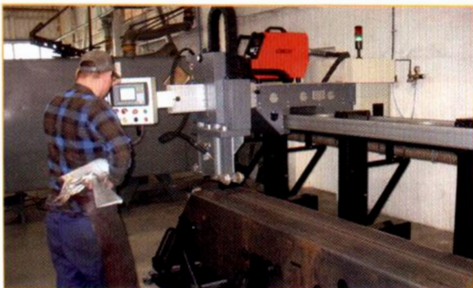
Rys. 1 Maszyna spawająca belki wysięgników
