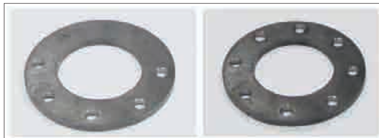
◀ Ilustracja 3: Przykład wykorzystania modułu punktowania plazmowego do oznaczenia miejsc wiercenia otworów
