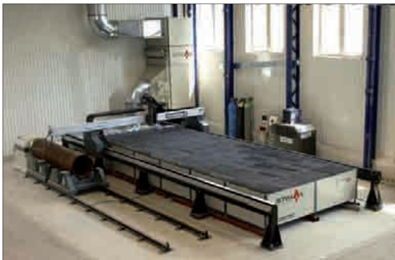
▲ Ilustracja 4: Maszyna VXstandard o obszarze roboczym 2500x6000 mm, wyposażona w wysięgnik portalu (zwiększający szerokość roboczą o 1 mb) i obrotnicę do rur
