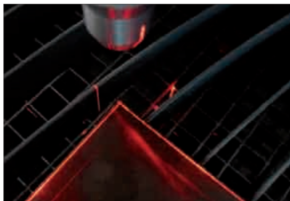
► Ilustracja 5: Przykład wykorzystania laserowego wskaźnika położenia do określenia punktu startowego cięcia
