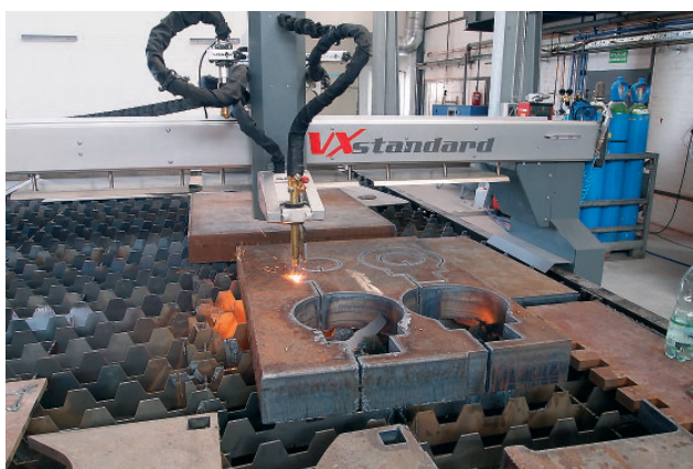
Multi3D pozwala na pracę różnymi narzędziami. Na zdjęciu cięcie palnikiem tlenowym
